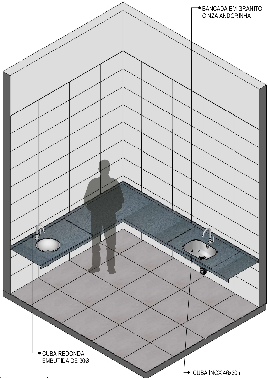
33 VISTA ISOMÉTRICA Escala: 1/25
