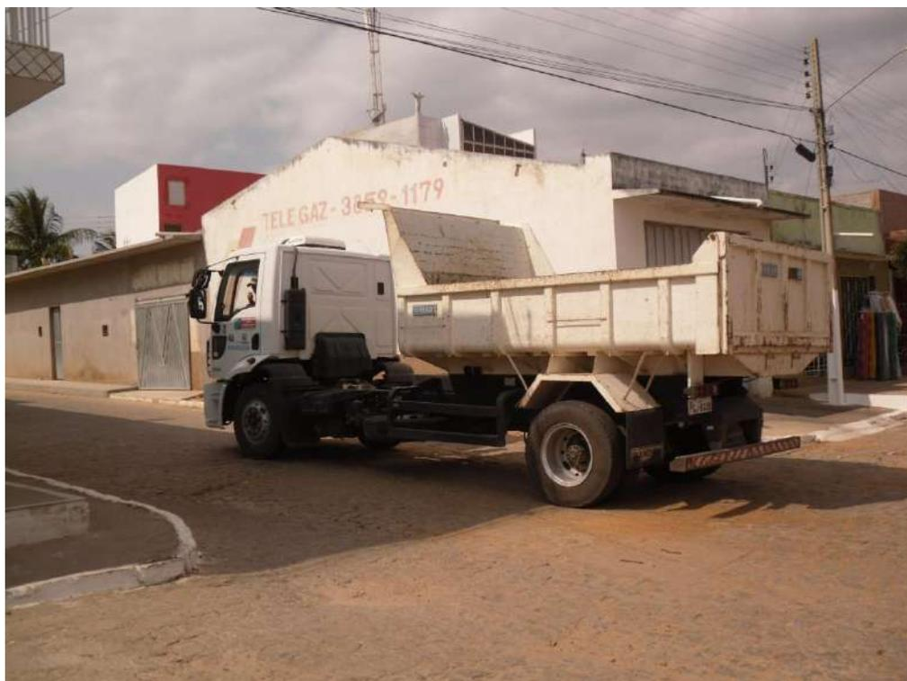
**Figura 4 – Caçamba basculante utilizado na coleta.**
